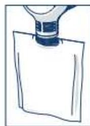
L'assenza di prodotto AcquaSIL 2/15° nella ricarica non viene segnalata da alcun dispositivo automatico, ma è visibile dallo svuotamento/schiacciamento della ricarica stessa.
