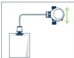
Dopo l'installazione dell'apparecchiatura, a seconda dello spazio utile disponibile, si può decidere di agganciare la ricarica di AcquaSIL 2/15® direttamente al corpo pompa MiniDUE (schemi in alto) o in versione remotizzata (schema a sx).
